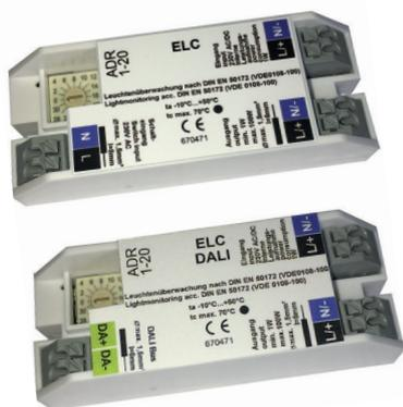
Schalt- und Überwachungsbaustein für Mischbetriebsstromkreise, in welchen bis zu 20 DS- und BS- Leuchten gleichzeitig betrieben werden können. Die Einstellung der Schaltungsart erfolgt ohne DIP-Schalter direkt über die Software der Anlage. Der Baustein verfügt über einen Schalteingang zur Mitschaltung der Allgemeinbeleuchtung oder einen DALI-Kontakt. Geeignet für Anlagen der Familie LPtouch/CPtouch.
