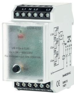
Die Dreiphasen-Netzüberwachung, findet Einsatz als Spannungswächter in Sicherheitsstromversorgungen. Es können max. 3 Phasen, die eine Wechselspannung von 230V gegen den Nullleiter führen, überwacht werden. Die DPÜ hat eine Statusanzeige und eine Testtaste.
