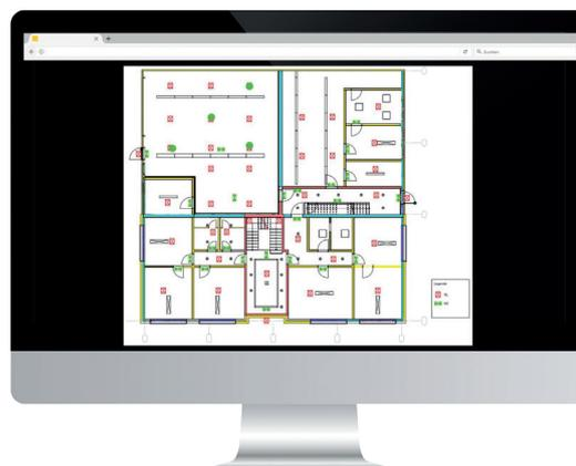
Durch die Gebäudevisualisierung erhalten Sie eine optische Darstellung der Sicherheitsbeleuchtung inkl. der Schalt-/Fehlerzustände.
