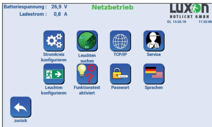
Das Konfigurationsmenü bietet in der zweiten Ebene weitere Möglichkeiten zur Steuerung/Konfiguration der Anlage, wie z.B. Stromkreis-Konfiguration (Stromkreis- oder Einzelleuchtenüberwachung), Leuchtensuche pro Kreis oder für alle Kreise bei Nachinstallation (Leuchten werden automatisch gescannt), Netzwerkeinstellungen, Passworteinstellungen, Leuchtenkonfiguration (Einstellung der Betriebsart DS/BS und Leuchtenzielort), Funktionstest aktivieren/deaktivieren (für Servicezwecke).
