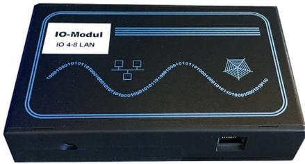
Über das IO-Modul in Verbindung mit dem VISU-TAB oder dem CPS/LPS Manager können Fremdanlagen mit überwacht werden. Zusätzlich verfügt das IO-Modul über 8 frei programmierbare Eingänge und 4 Relaisausgänge für vielfältige Steuerungsaufgaben. Das IO-Modul und die Anlagen können über ein vorhandenes Firmennetzwerk oder über einen einfachen Switch per LAN vernetzt werden.
