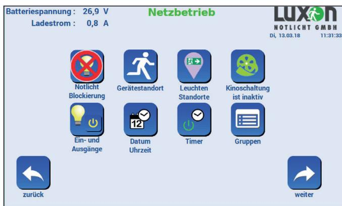
Das passwortgeschützte Konfigurationsmenü bietet in der ersten Ebene die Möglichkeiten zur Steuerung der Anlage, wie z.B. Notlichtblockierung, Kinoschaltung (BS manuell quittieren), Gruppenbildung, Belegung der Ein- und Ausgänge für Schalt- und Meldefunktionen (Schalten von Gruppen oder einzelnen Leuchten, Störungsmeldungen für GLT) und Steuerung durch bis zu 24 Timer.
